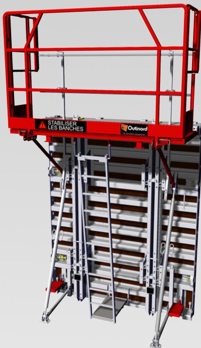
La banche TPMAX est une banche haute performance conçue pour la réalisation de grands ouvrages de génie civil. Sa conception robuste et sa flexibilité lui permettent de couler des voiles bétons à haute densité de ferrailage. Sa peau contreplaquée vissée par l'arrière garantit des surfaces de béton de qualité élevée.
