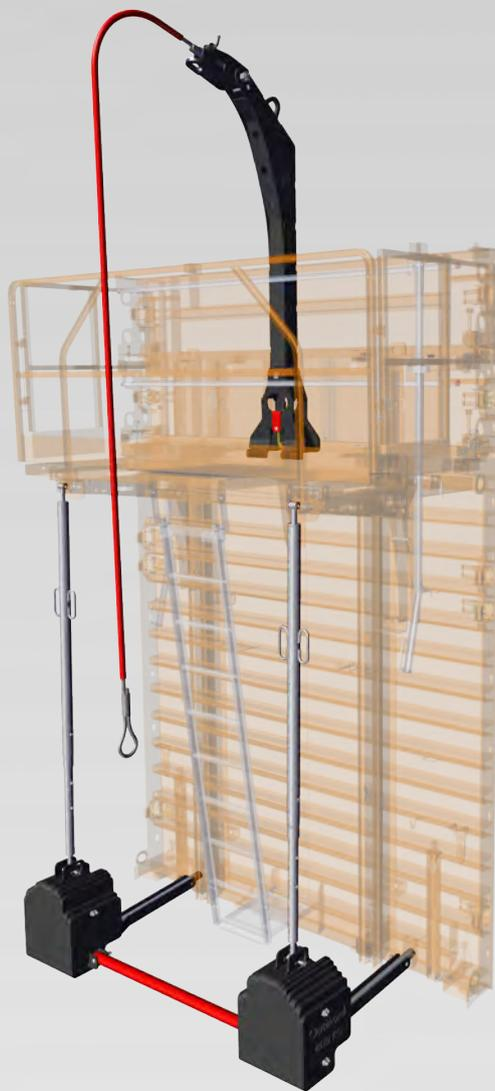
Le système KALE (Kit Auto-Lest Evolution) permet la stabilité du coffrage dans toutes les phases d'utilisation. Il est utilisable sur des colis de banches de hauteur 3,8m maxi. Il est simple d'emploi et sa mise en œuvre se fait sans outil spécifique.
