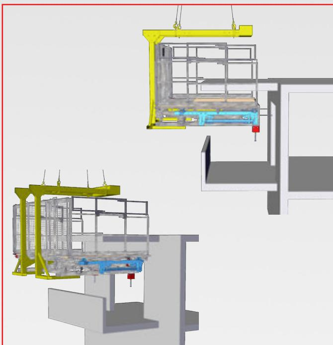
Coffrage et décoffrage à l'aide d'un palonnier de levage équilibré.
